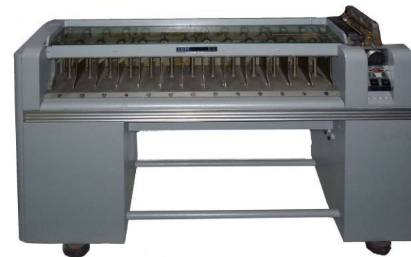
IBM sorteermachine van ponskaarten
