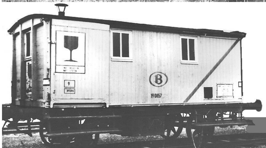
Fig. 8.30 Wagen 190.857 ex EB 59265 ES groep Gent station Denderleeuw typische houten opbouw
