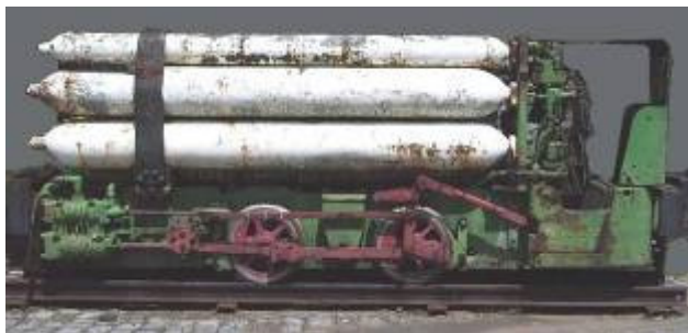
Fig. 16.5 Persluchtloc van de mijn Beringen
