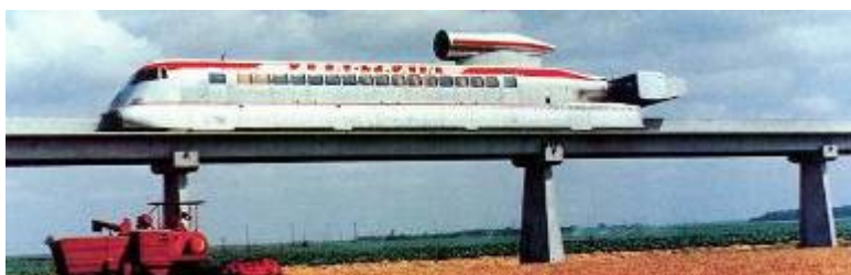
Fig. 16.6 Luchtkussentrein I80 met straalmotor, er bestonden ook prototypes met propellers. Foto uit www.retronaut.com
