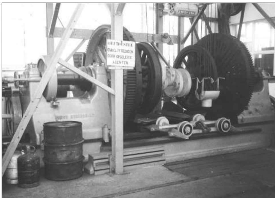
Fig. 10.5 Wieldraaibank – Het opgestelde wielstel tussen de klauwen is een krukswielstel van een H1 type 44.
