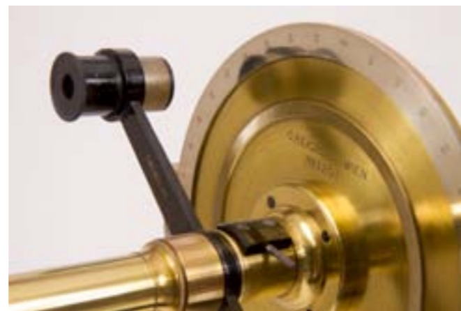
Fig. k.4.6 Polarimeter C. Reichert Wenen met rechts detail afleesschaal
