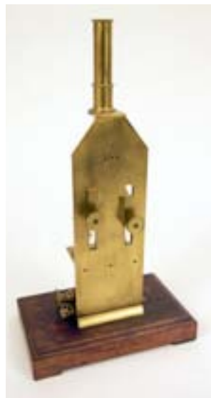
Fig. k.4.5 Colorimeter Duboscq, resp. voorkant, achterkant en detail afleesschaal
