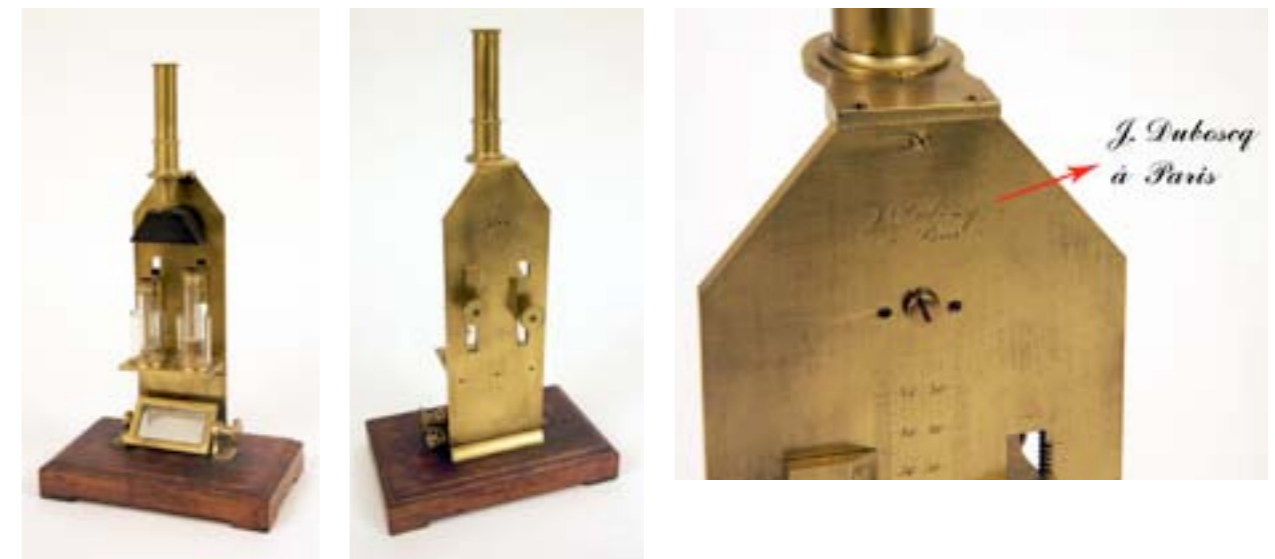
Fig. 4.5: Colorimeter Duboscq, resp. voorkant, achterkant en detail afleesschaal
