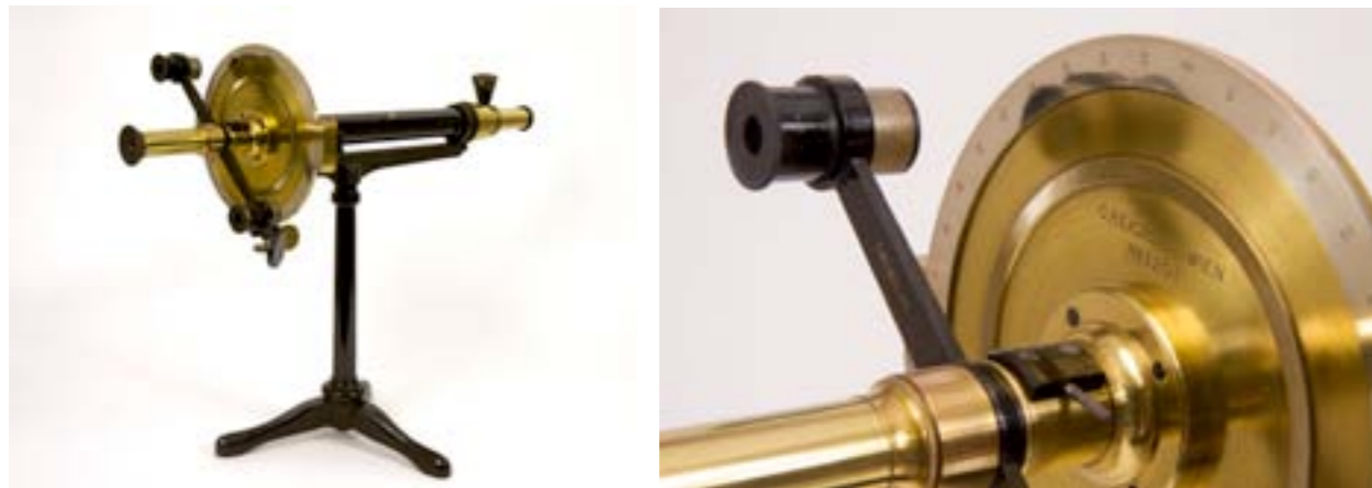
Fig. 4.6: Polarimeter C. Reichert Wenen met rechts detail afleesschaal, zie ook fig. k.4.6
