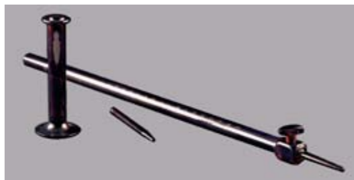
Fig. 4.7: Buret in bakeliet voor de bepaling van fluorverbindingen (Baekeland)
