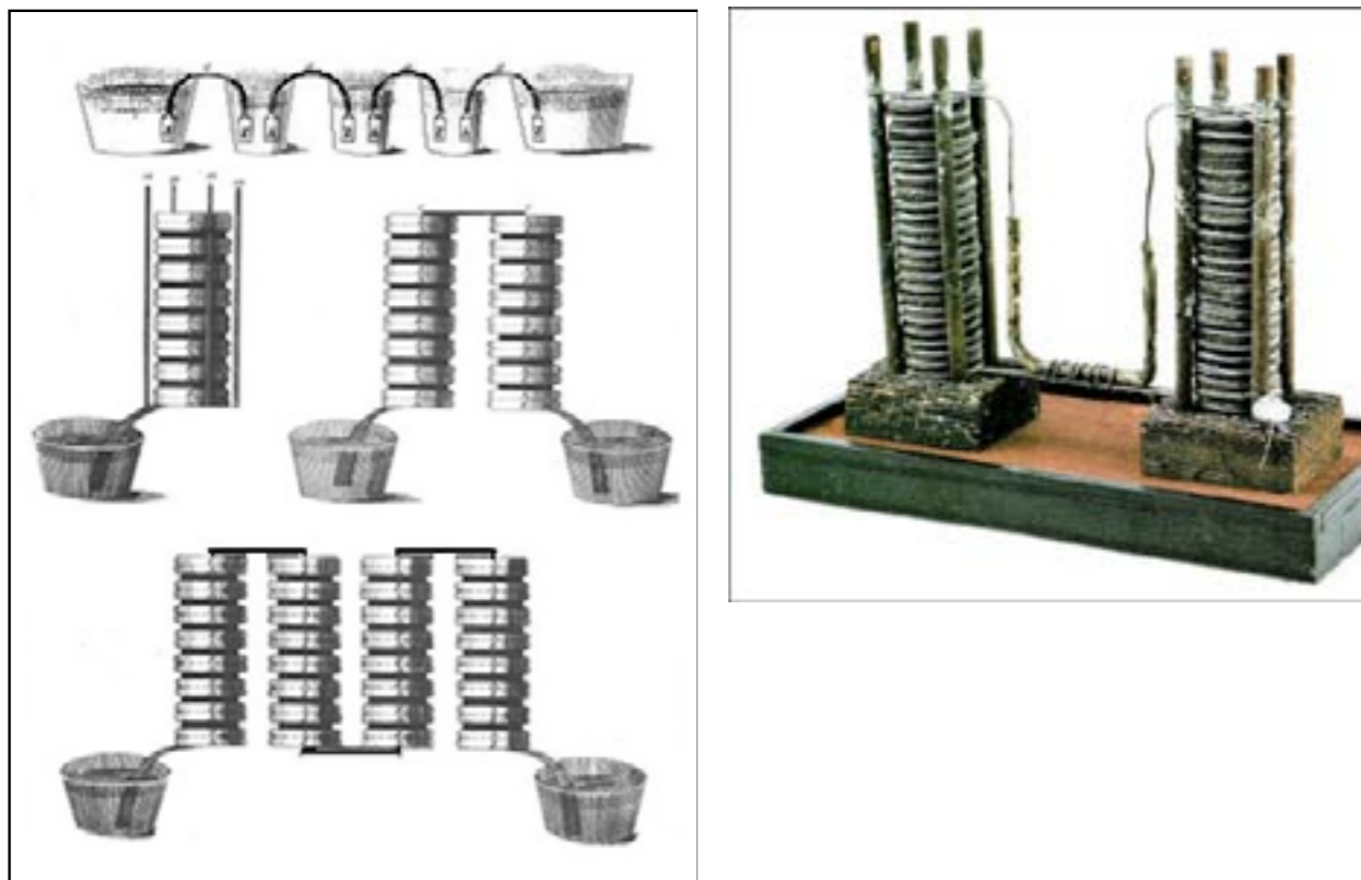
Fig. 8.2 Metaalplatenzuil (1800) en elektrolysetoestel van Alessandro Volta (1745-1827) (zie ook fig. k.8.2)
