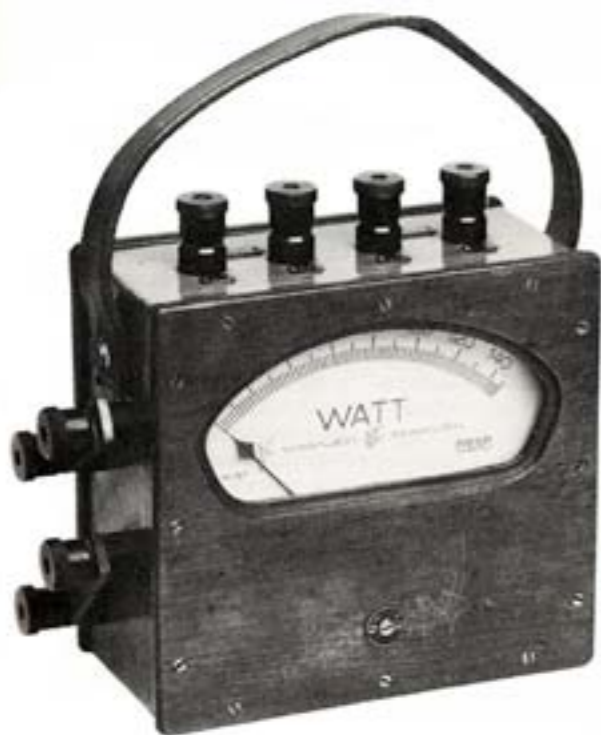
Foto 3.1 Draagbare NIEAF Wattmeter (1930) Uit Instrumenten, Wetenschap en Samenleving van J. Mooij
