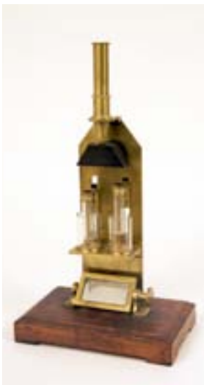
Fig. k.4.5 Colorimeter Duboscq, resp. voorkant, achterkant en detail afleesschaal
