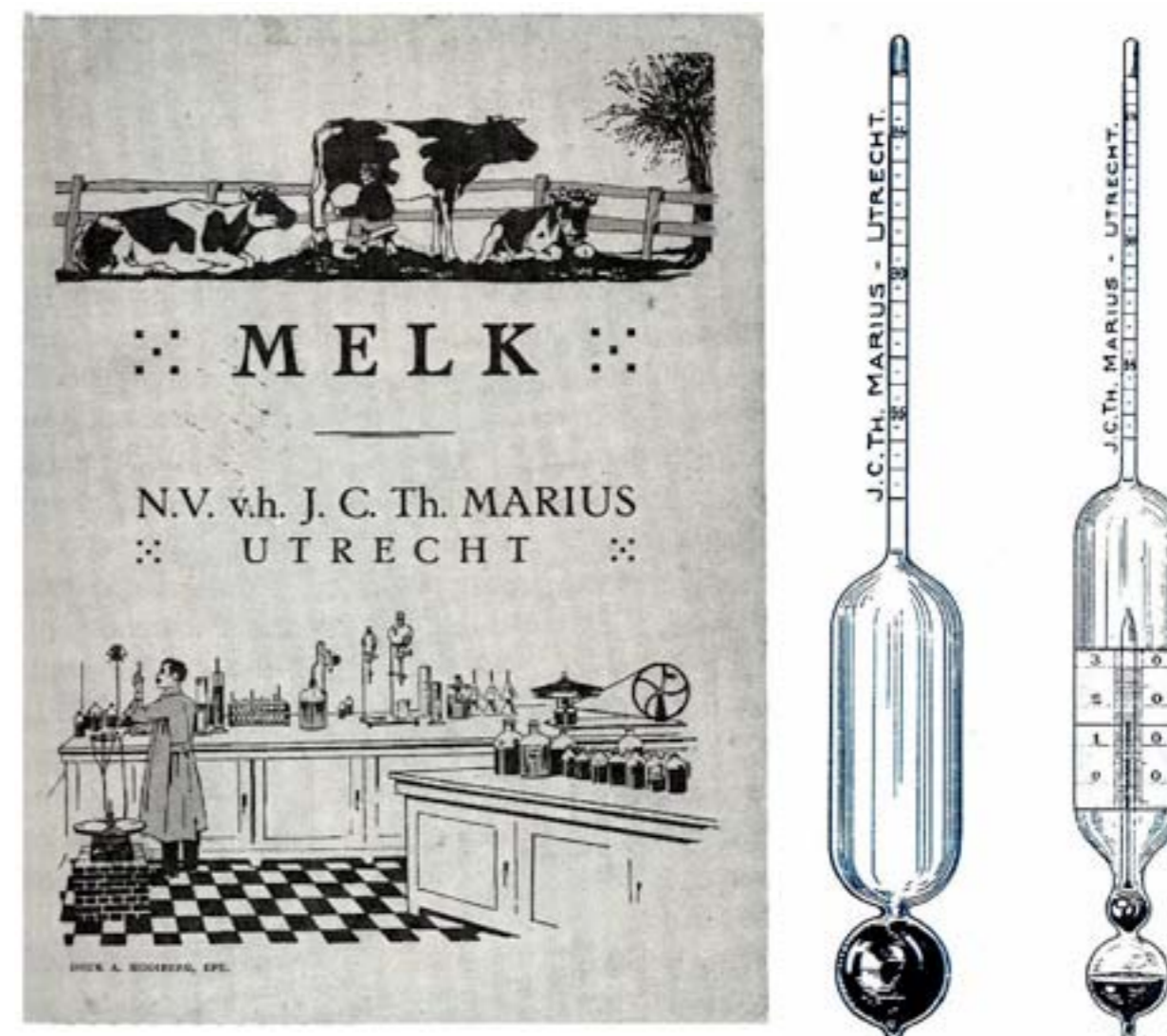
Fig. 3.3 Prijscourant uit begin deze eeuw met lactodensimeters voor bepalen soortelijke massa van melk Uit Instrumenten, Wetenschap en Samenleving van J. Mooij
