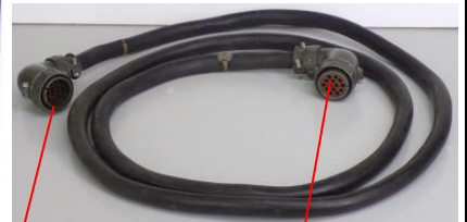
kabel tussen voedingsblok en zender
