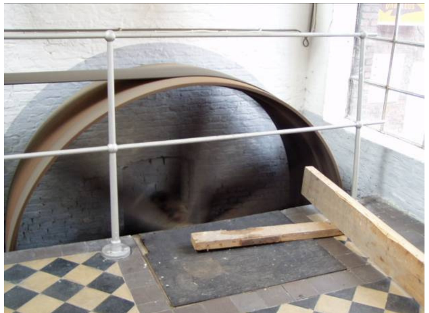
Fig. 7 Draaiend (met de houten balk werd het groot vliegwiel losgewrikt.
